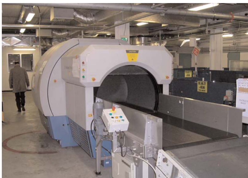
Foto 2. Aeroporto di Milano Linate. Impianto di smistamento e controllo bagagli: apparecchiatura EDS (Explosive Detection System). Foto di Galileo Tamasi.
